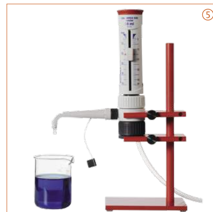
Supporto e tubo di alimentazione per aspirazione remota
