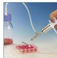
Aspirazione tramite valvola di modo inverso
